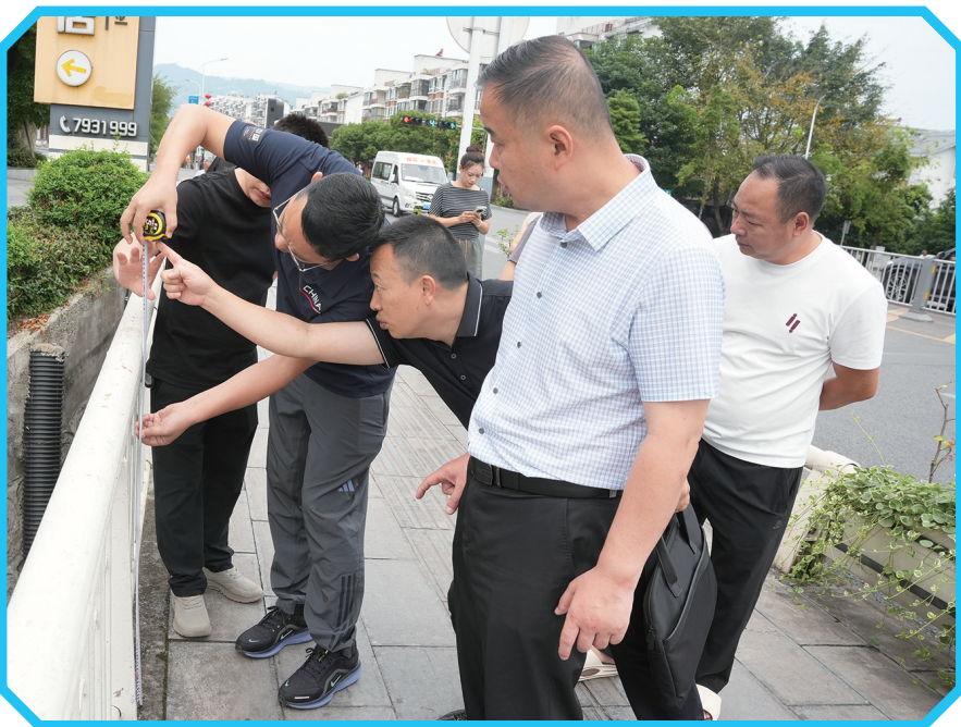
工作人员测量四方桥护栏安全高度。
